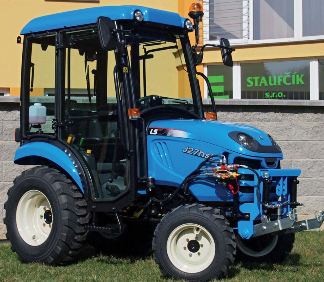
Model J27 HST - vytápěná kabina, přední závěs a přední hydraulický rozvod jsou prvky volitelné výbavy
